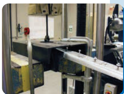
Thí nghiệm chịu kéo Tensile withdrawal test
