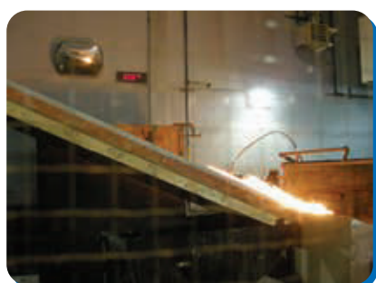
Thí nghiệm cháy lan theo tiêu chuẩn ASTM E108 ASTM E108 spread of flame tests
