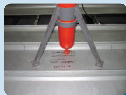
Thí nghiệm khả năng chịu tải trọng hoạt tải lắp đặt Resistance to Foot Traffic test
