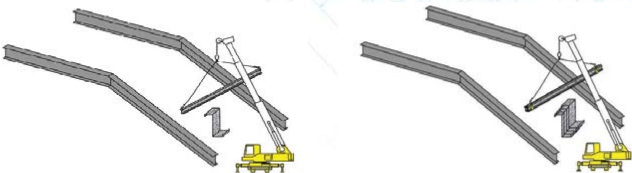
ภาพแสดง การนำแปขึ้นติดตั้ง รูปแบบที่ไม่ใช่การติดตั้งที่ต่อเนื่องกัน 2 รูปแบบ
